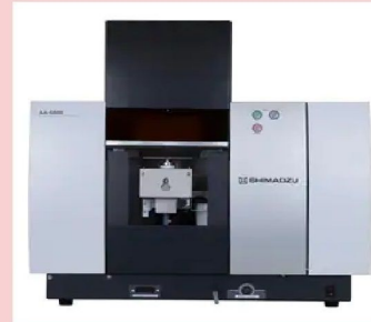
Atomic Absorption Spectrofotometer (AAS) Shimadzu AA-6880 & GBC Explore AA Untuk Analisis Mineral dan Logam Berat
