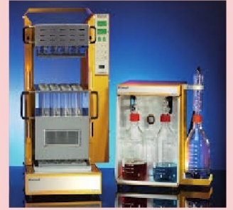
Block Digestion & Distillation Unit Untuk Analisa Total Nitrogen Metode Kjeldahl
