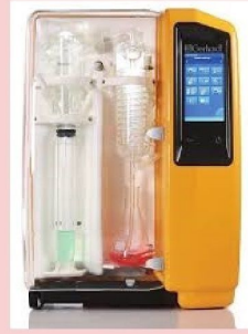
Block Digestion & Distillation Unit Untuk Analisa Total Nitrogen Metode Kjeldahl
